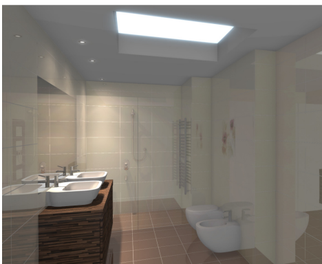
Rys. 335 - RENDER PODSTAWOWY: W scenie są 3 halogeny i materiał w suficie, który ma nadaną emisję (podstawową) i jedynie symuluje światło (włączony efekt „Prezentacji emisji” - wydzielania poświaty). Podczas renderowania użyto funkcji „Ambient Occlusion” i lekko rozjaśniono scenę (funkcja „Jasność”).
