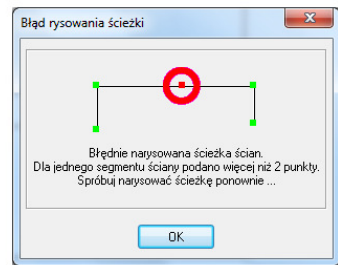
Rys. 97 – komunikaty o błędnie wyrysowanej ścieżce ścian
