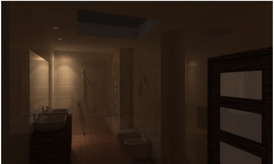
Rys. 488 - RENDER ZAAWANSOWANY: Do oświetlenia sceny użyto tylko jednego halogenu - jak widać, mimo niskiego poziomu jasności wszystkie szczegóły w projekcie są widoczne, a oświetlenie wygląda bardzo naturalnie. Widoczne barwy są efektem sposobu wyliczania oświetlenia i zjawiska przechodzenia kolorów ( Colour Bleeding )
